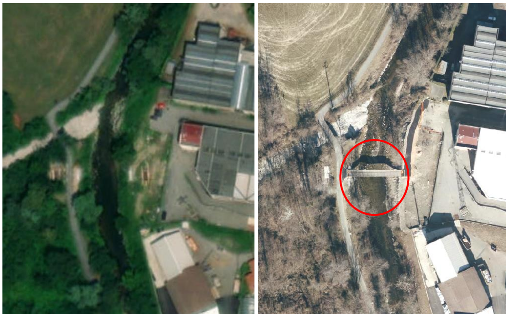
Figura 39: confronto tra ortofoto con evidenziata una nuova opera di attraversamento sul Torrente Grantorella
